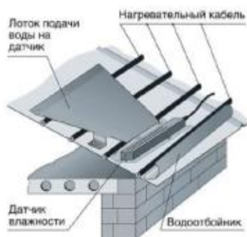
Датчик на фальцевой кровле
